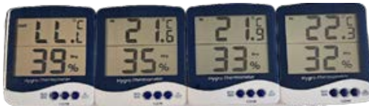
Gängige Hygrometer verlieren schnell ihre Kalibrierung.
